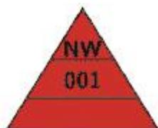
3.2 Das Sicherungszeichen des Instandsetzers besteht aus einer dreieckigen Klebmarke mit einer Seitenlänge von mindestens 7 mm. Die Rückseite des Sicherungszeichens in der Ausführung als Plombe darf mit einem Firmenzeichen versehen sein.
