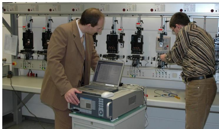
*Überwachung einer Prüfstelle für Messgeräte für Elektrizität*
