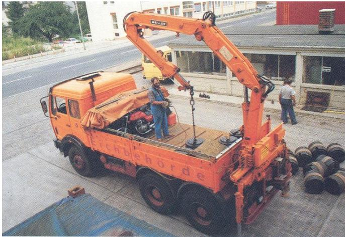
Zur Fahrzeugkonzeption gehörte der als „Normallast“ geprüfte 30-Tonnen-Anhänger. Weiterhin war der LKW mit einem Hydraulikkran ausgestattet, um die Rollgewichtstücke auf- und abladen zu können. Die Gewichtstücke konnten dann von einer Person von der Fahrbahn auf die Waagenbrücke gerollt werden. Das neue Konzept war so erfolgreich, dass das Eichfahrzeug ab dem ersten Jahr über 200 Einsatz-tage im Jahr hatte.
