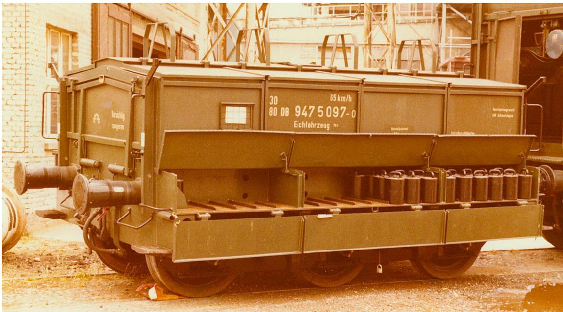
Diese Eichwaggons waren mit Rollgewichtstücken von 2 t bis zu 5 t bestückt. Die Rollgewichtstücke hatten eine Lauffläche, mit der sie auf Schienen bewegt werden konnten.
