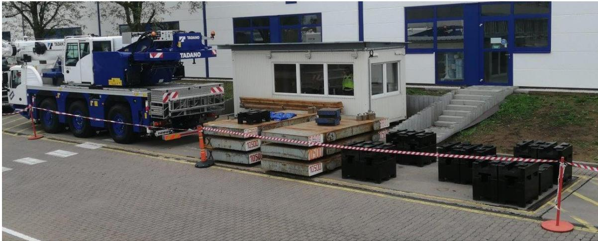
Eichungen können in dieser Konstellation jedoch nicht mehr durchgeführt werden. Aktuell erfolgt der Transport der Prüfmittel für Eichungen in der Regel mit zwei LKW durch private Anbieter oder die Messgeräteverwender müssen in der glücklichen Lage sein, erhebliche Mengen an Ersatzlast (in obiger Abbildung beispielhaft: ein Kranfahrzeug plus mehrere Tonnen Kontergewicht des Kranfahrzeuges) selbst stellen zu können. Hier müssen langfristig jedoch alternative Lösungen gefunden werden.
