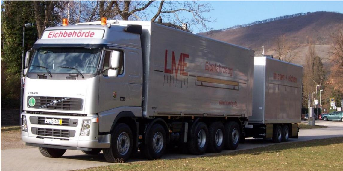
Auf dem Zugfahrzeug und dem Anhänger befanden sich 27 Tonnen Normallast in Form von 1000 und 500 Kilogramm Blockgewichtstücken, sowie weitere Gewichtstücke, um allen Anforderungen an die Aufteilung der Prüfpunkte gerecht zu werden.
