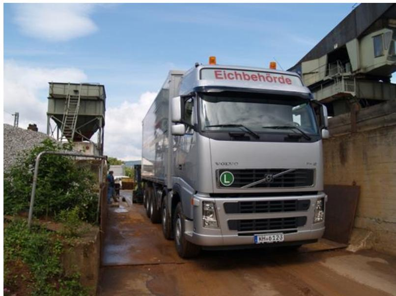
*Bild: Belastungsfahrzeug des LME RLP*
