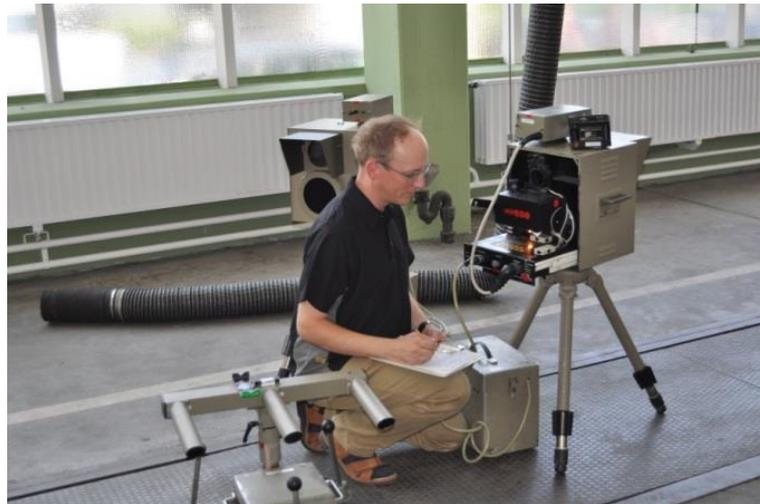
*Bild: Michael Döhren bei der Eichung eines Lichtschranken-Geschwindigkeitsmessgerätes*
