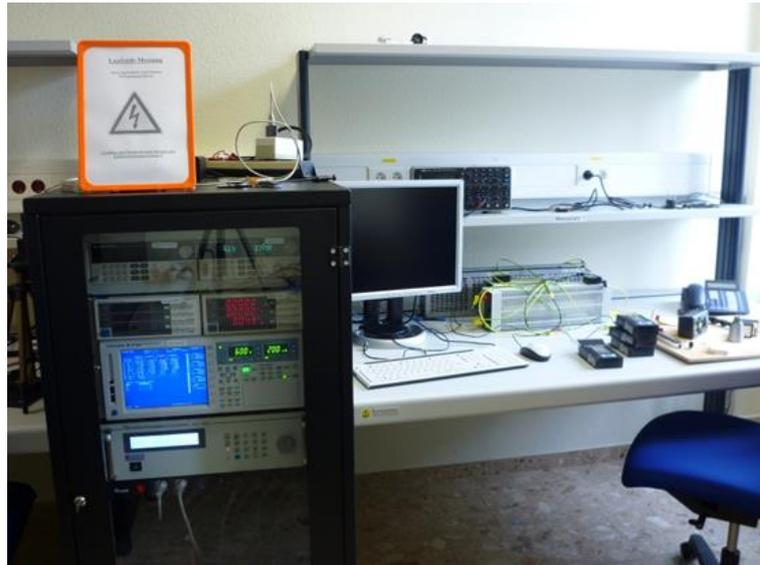
*Bild: Prüfstand zur Messung der Netzteil-effizienz bei der HED*
