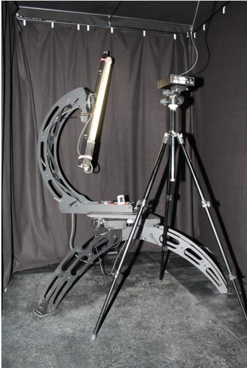
*Bild: Photogoniometer zur Messung von Lichtquellen*
